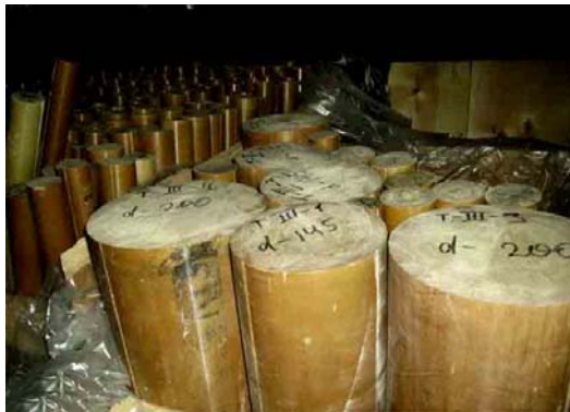
Рисунок 7 – Текстолит для изготовления центральной части ленточного супермаховика.
