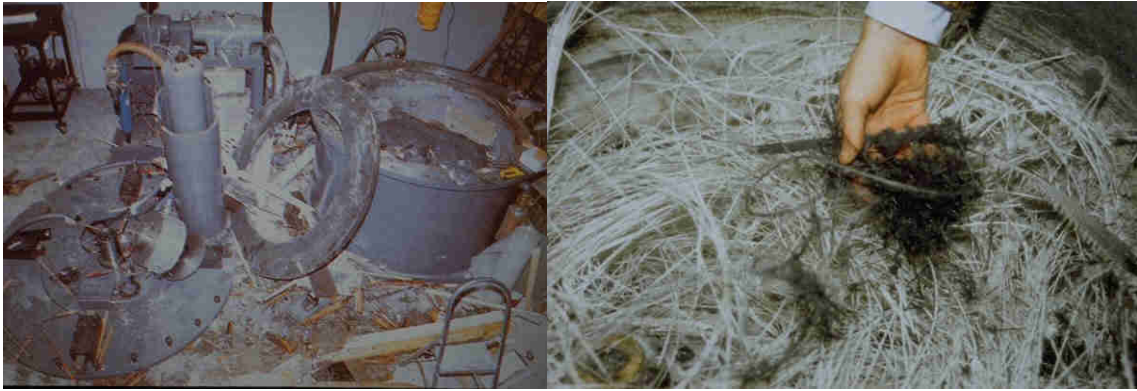
Рисунок 2 – Последствия разрыва волоконного супермаховика.
